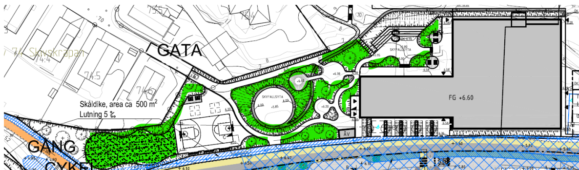
Figur 10. Dagvattenrening och fördröjning behöver en yta på 480 m 2 regnbäddar vilket med fördel kan samordnas med grönytor som planeras inom skolområdet (grönt i bild).
