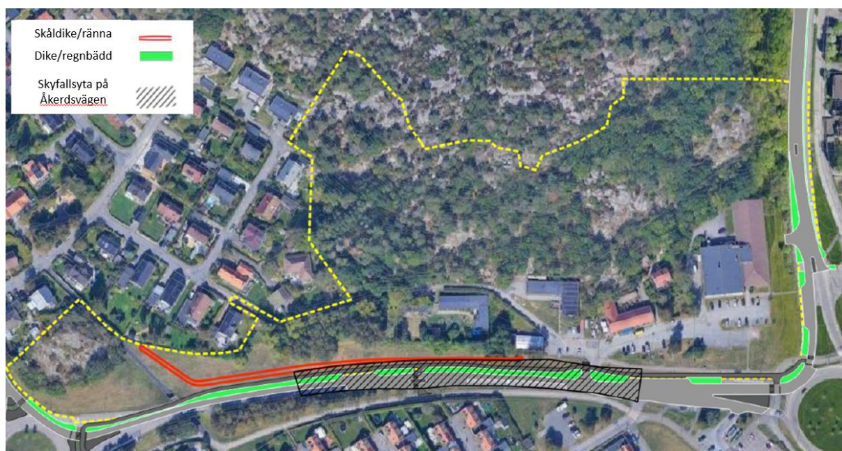
Figur 11. Ytor för hantering av dagvatten och skyfall inom allmän plats. Gröna ytor kan utformas som svackdike eller regnbädd och ska hantera dagvatten och skyfall. Röd yta är en ränna dit skyfall avleds. Streckad markering visar utbredning av skyfallsvatten över vägen.
