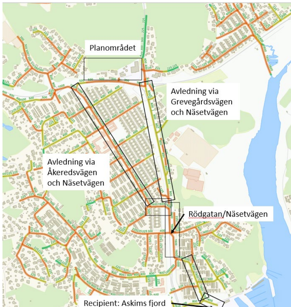
Figur 6. Avvattning till havet (Askims fjord) kan ske via Åkeredsvägen, förbi Åkeredsskolan och Näsetvägen eller via Grevegårdsvägen och Näsetvägen. På ledningssträckorna uppstår marköversvämning vid klimatanpassat 20-års regn (orange sträckor) och det varnas för vattennivåer över ledningshjässa (gul sträcka) [VA-banken, 2024].
