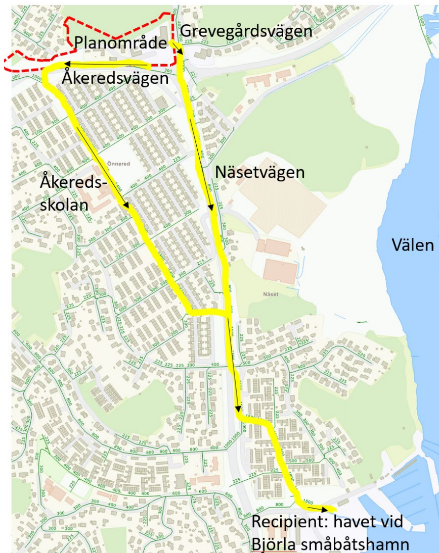
Figur 5. Planområdet (röd streckad linje) med dagvattenförande separat ledningssystem (grönt). Gul linje med svarta pilar visar att det finns två möjliga avledningar från planområdet. Större delen av planområdet avvattnas idag åt söder till Åkeredsvägen. En mindre del i planområdets nordöstra del avvattnas mot Grevegårdsvägen. Båda avleder dagvattnet till recipienten havet (Askims fjord) vid Björla småbåtshamn [VA-banken, 2021].
